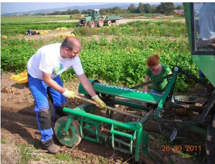
Abbildung 9: Durchführung der Zeiternte mit dem Schwingsiebroder
