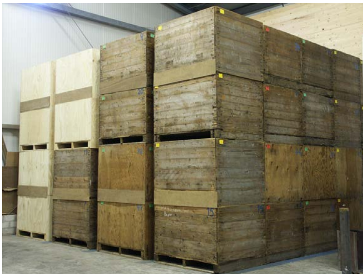
Abbildung 11: Aufstellung von zwangsbelüfteten Großkisten mit Lagerproben vor einer praxisüblichen Belüftungswand im Lager der Versuchsstation Dethlingen
