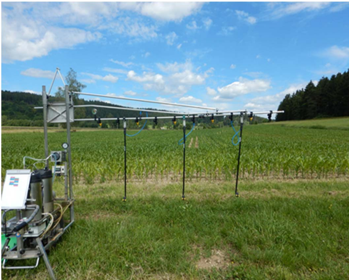
Abb 1: Parzellenspritzgerät mit der Dropleg-Technik.
