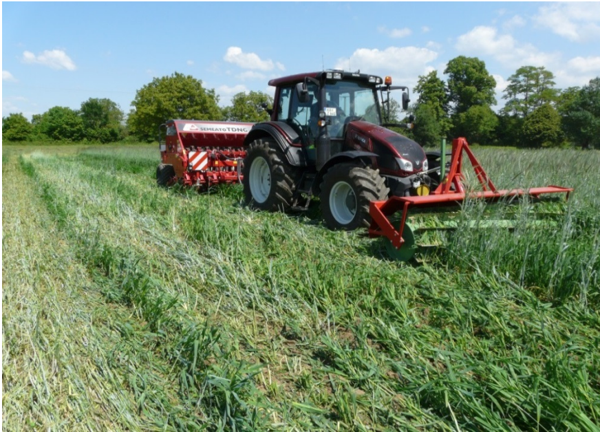
Abbildung 2: Walzen des Roggens mit Messerwalze und Aussaat mit Semeato in einem Arbeitsgang.
