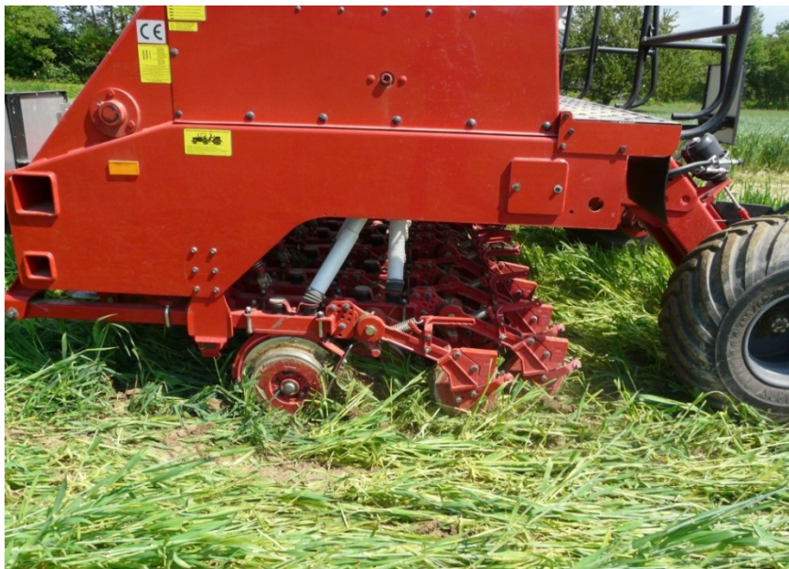
Abbildung 3: Rollschare der Semeato. Sie schneiden durch die Roggendecke und ermöglichen eine sichere Ablage.
