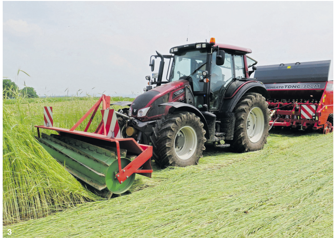
2 Roggendurchwuchs ließ sich nicht immer vollständig vermeiden. | 3 Die Messerwalze soll die Halme zusätzlich knicken und somit den Assimilatfluss unterbrechen. | Fotos: Haak
