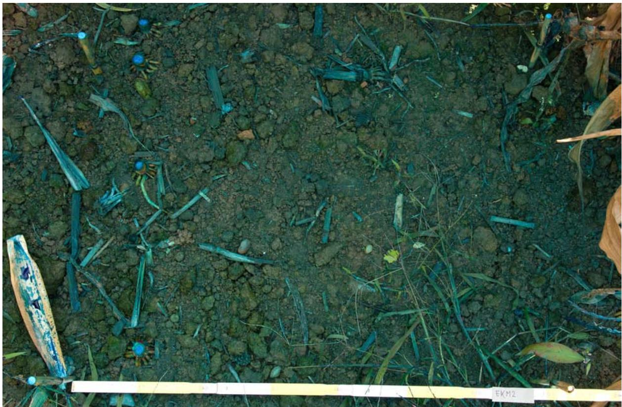
**Bild 10: Boden nach Aufbringung der Brilliant-Blue-Lösung**
