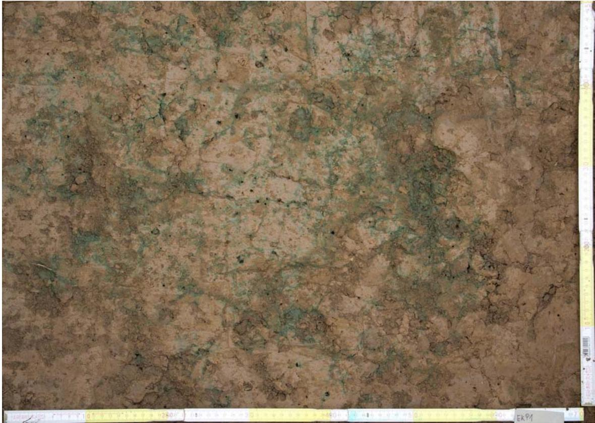
Bild 12a: Horizontalschnitt Pflugvariante in 40 cm Tiefe
