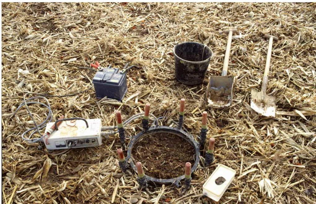
Bild 2: Geräte für Elektrofang und Handauslese. Das Foto wurde im Herbst 1998 am Standort Efringen-Kirchen aufgenommen. Energiequelle für den Elektrofang ist eine 12V-Bleibatterie. Das Regenwurmfanggerät (vorne links) wandelt den 12V Gleichstrom in Wechselstrom-Impulse von 100-600 V (regelbar) um. Diese werden von 8 kreisförmig angebrachten Metallstäben in den Boden geleitet. Rechts vorne ist ein Sammelgefäß. Die Regenwürmer werden auf feuchtem Fließpapier gehältert und bis zur Bestimmung gekühlt. Hinten rechts sind Spaten und Eimer für die Handauslese (der Spezialspaten neben dem Eimer wurde 2011 nicht verwendet).
