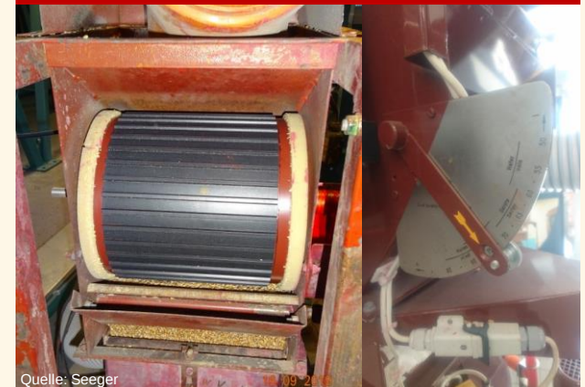
Zu 5.11K Saatgutdosiereinrichtung
