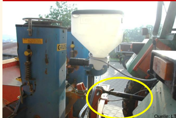
Zu 1.3K Befestigung der Granulatstreuer
