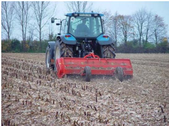
**Abb. 2: Maisstrohzerkleinerung mit Mulcher**
