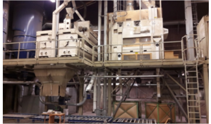
Reinigungsanlage der ZG Raiffeisen eG in Hüfingen; links die Trieure und rechts die Sieb- und Aspirationsanlage Foto: Götz Lechler/ZG
