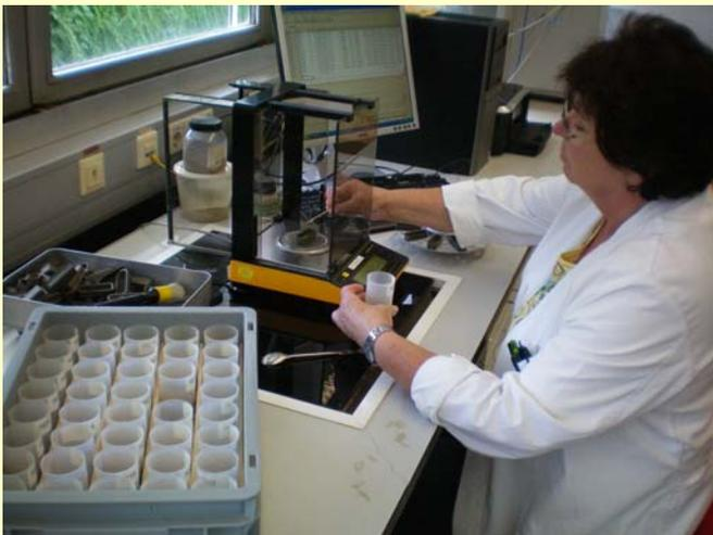
Einwaage einer Probe
