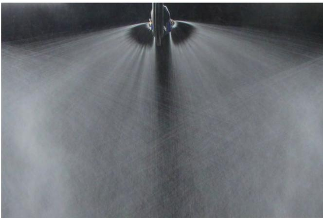
Bild 2: Überlappende Spritzfächer der Zungendüsen.
