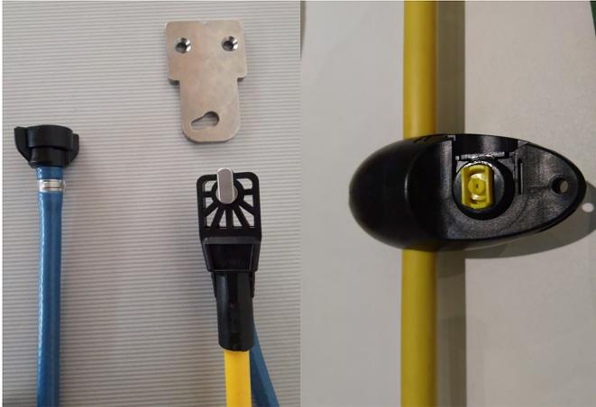
Bild 5: Links: Bajonettanschluss und Montageplatte. Recht: Am Beluga Düsenkörper werden Düsen mit einem Schieber fixiert.
