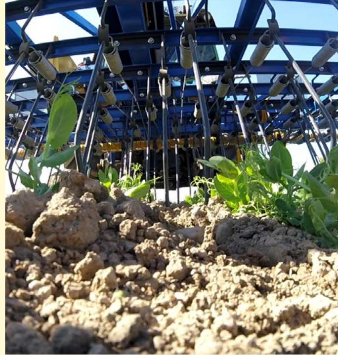
*Mechanische Unkrautbekämpfung durch einen Striegel*
