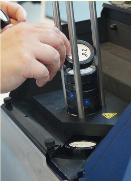
*Befüllen des Analysators mit Proben*
