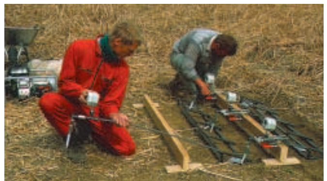
Ermittlung des Bodendrucks mittels Sonden (Würfel, Karlsruhe)
