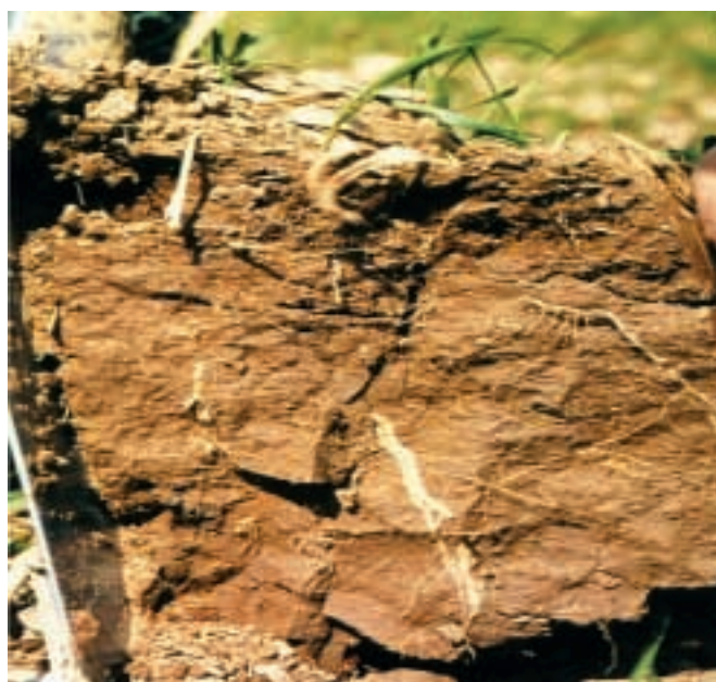
Schadverdichtete Struktur: kompakt, porenarm, scharfkantig (LPB, Freising)
