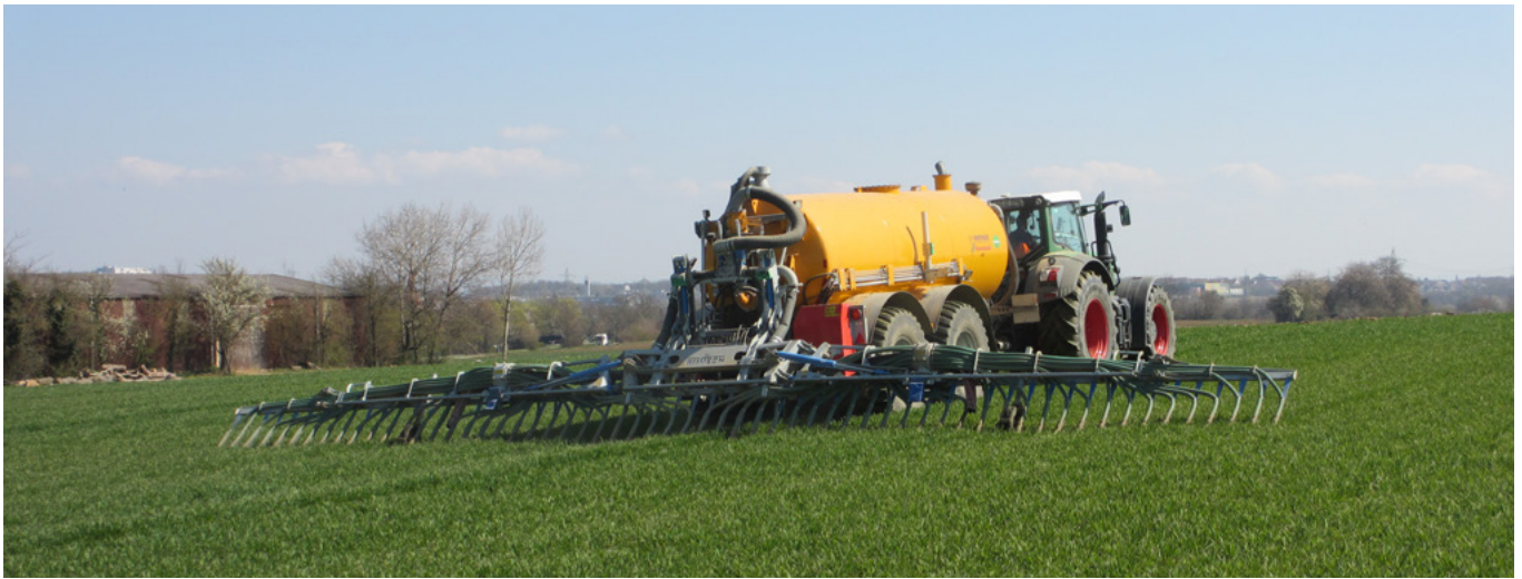
Verlustarme Gülleaufbringung mit Schleppschuhverfahren
