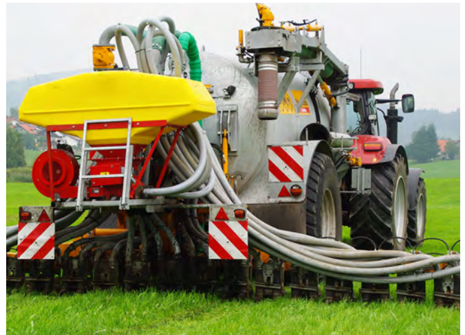
Samenbeimischung bei Gülleinjektion
