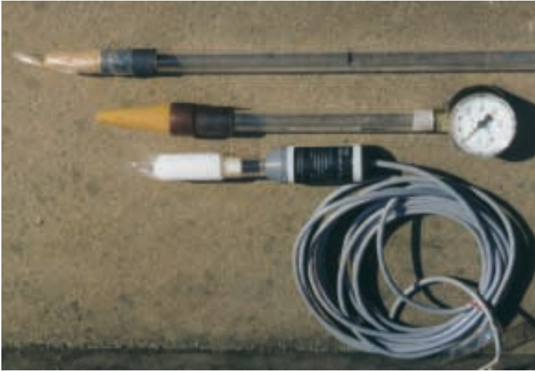
Bild 3: Tensiometer für verschiedene Bodentiefen.
