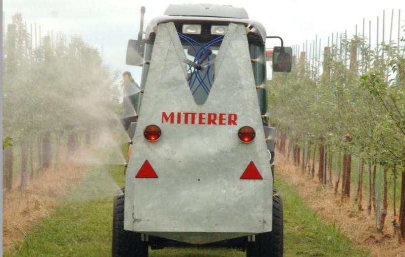
**Axialsprühgeräte** (max. 810 mm Ø)
