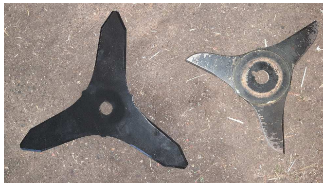
Bild 4: Links neuwertiges Dickichtmesser für Freischneider, rechts abgenutztes, einseitig und falsch geschliffenes Dickichtmesser.
