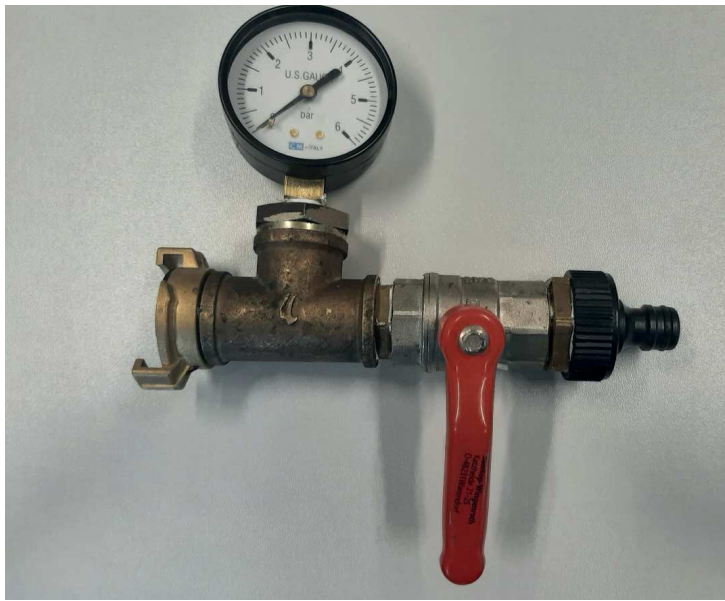
Bild 2: Einfache Konstruktion zur Druckermittlung mit Manometer und tränkseitigem Abspernhahn
